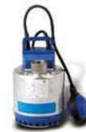
Pompe de relevage 358 roue Vortex Réf. 247865 Pour Eaux chargées et Eaux claires IP68. Granulométrie ø maxi : 50 mm
